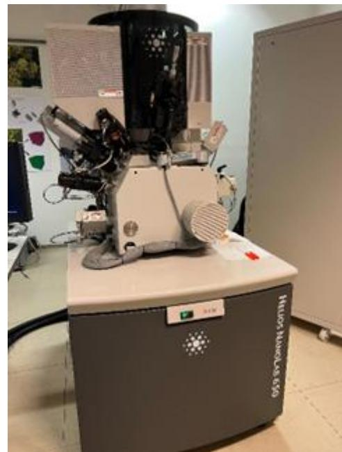
Slika 24. FIB-SEM/EDS mikroskop.
