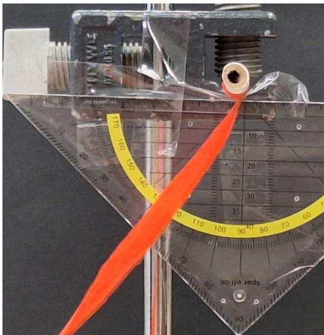
*Slika 17: Odklon zastavice pri razdalji elektrod 3,5 cm (foto: B. Kortnik)*
