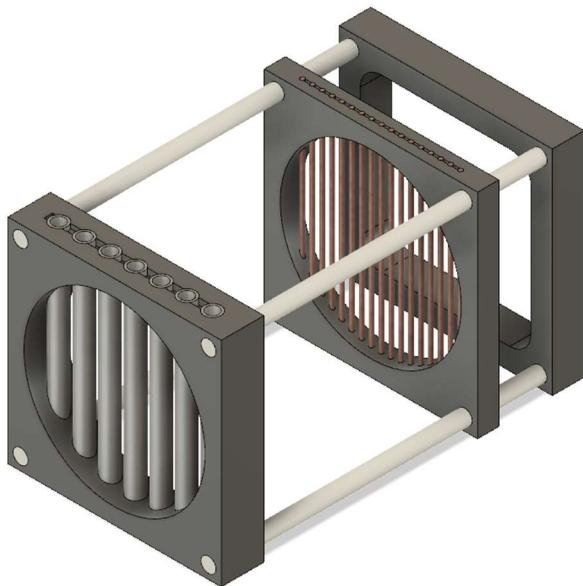
Slika 6: Model prototipa ionskega pogona (foto: B. Kortnik)
