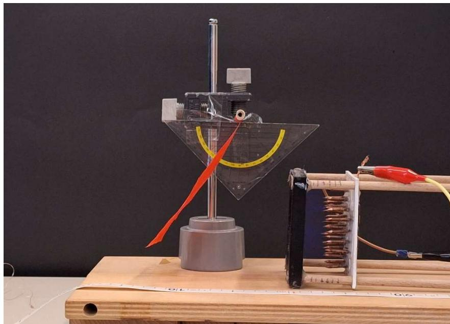
Slika 15: Anoda s špicami, razdalja med elektrodama 5 cm (foto: B. Kortnik)
