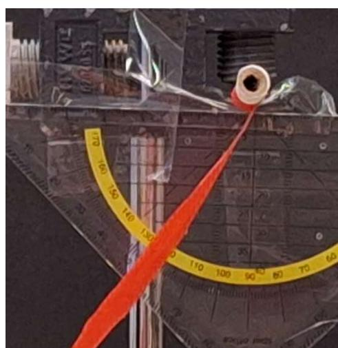
Slika 16: Odklon zastavice pri razdalji elektrod 4 cm (foto: B. Kortnik)
