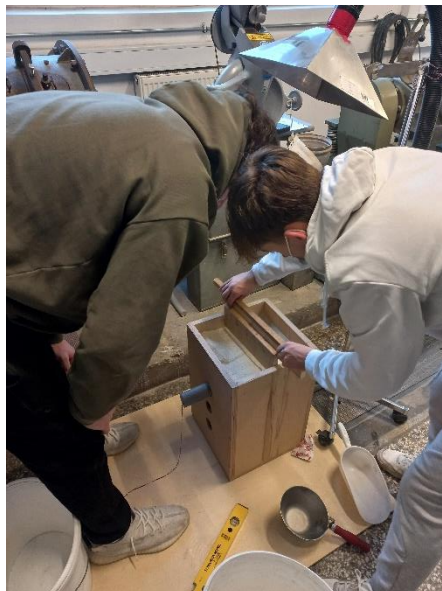
Slika 9. Uporaba pripomočka za ravnanje površine peska..
