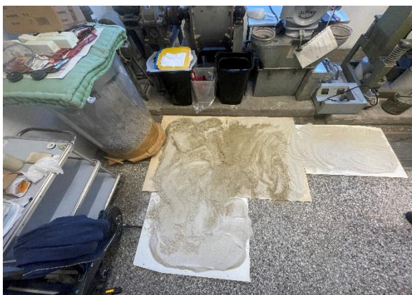
Slika 7. Prikaz procesa sušenja peska.
