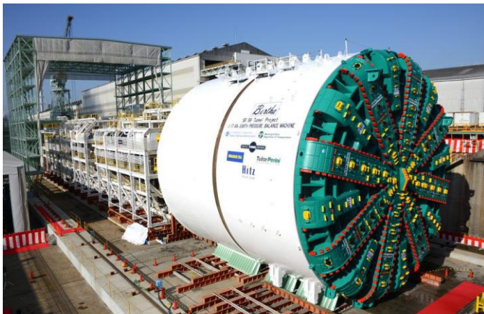
Slika 2. Stroj TBM s štitom [5].
