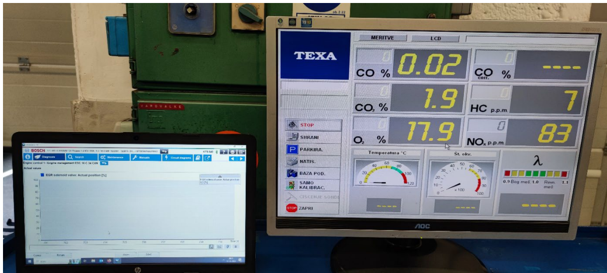
Slika 8: Meritev NO x , EGR_OFF, DPF_ON
