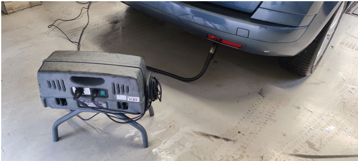
Slika 4: Merilni vmesnik za merjenje trdih delcev v izpustu
