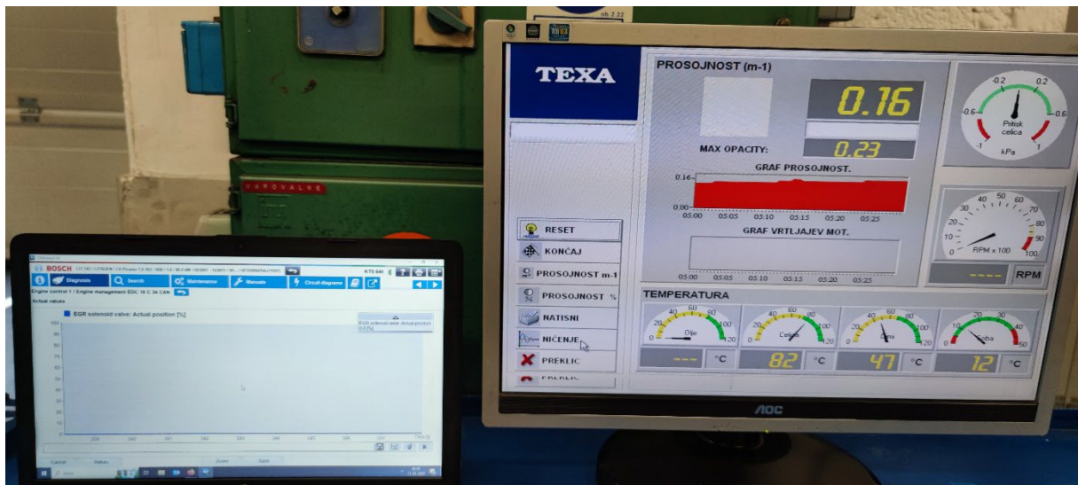
Slika 9: Meritev trdih delcev, EGR_OFF, DPF_ON
