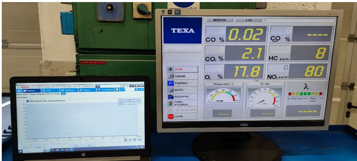
Slika 12: Meritev NO x , DPF_OFF, EGR_OFF
