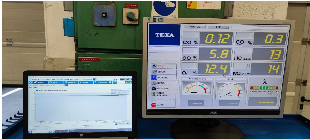
Slika 10: Meritev \text{NO}_x , DPF_OFF, EGR_ON
