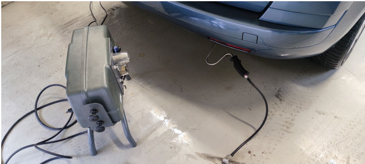
Slika 5: Merilni vmesnik za merjenje sestave izpušnih plinov
