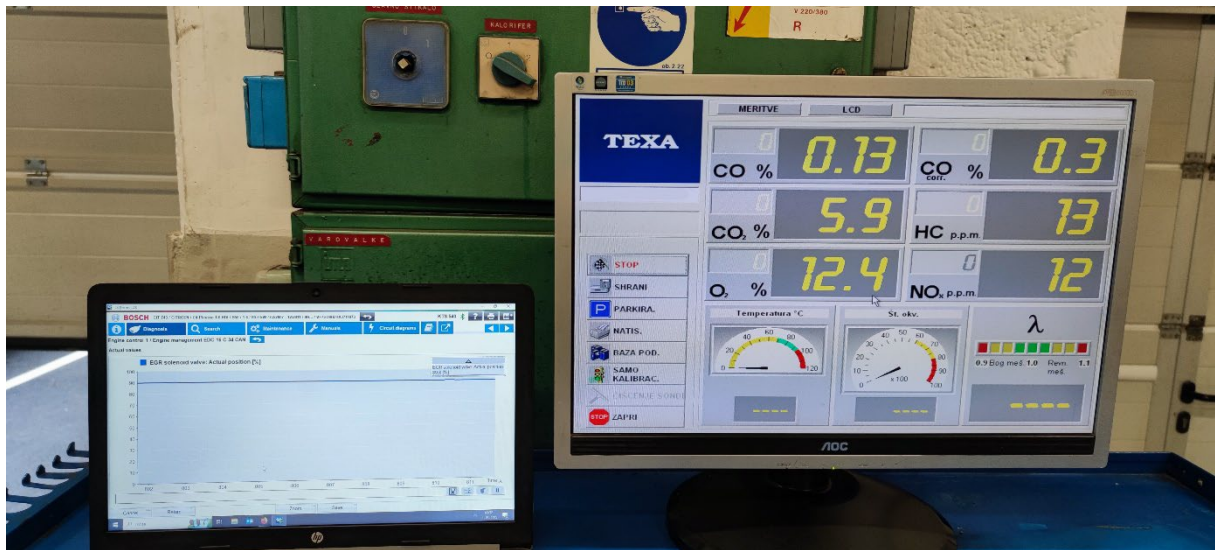
Slika 6: Meritev NO x , EGR_ON, DPF_ON
