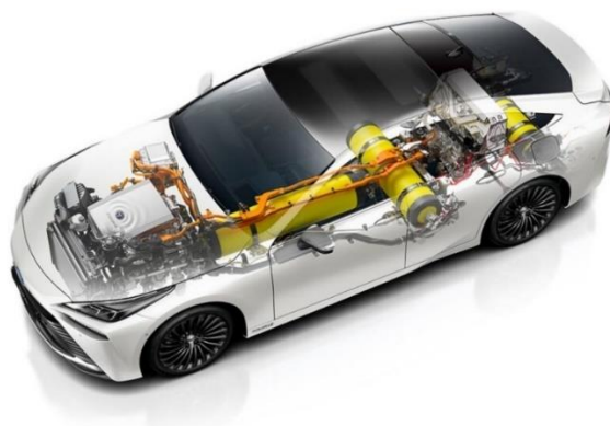
Slika 7: Sestava vodikovega avtomobila Toyota MIRAI II (10)
