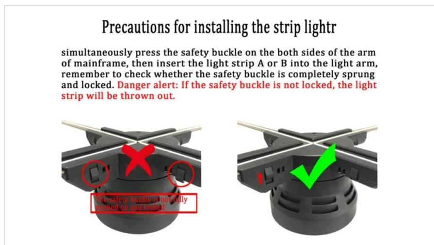
Slika 6: Navodilo za pravilno in varno sestavo hologramskega ventilatorja
