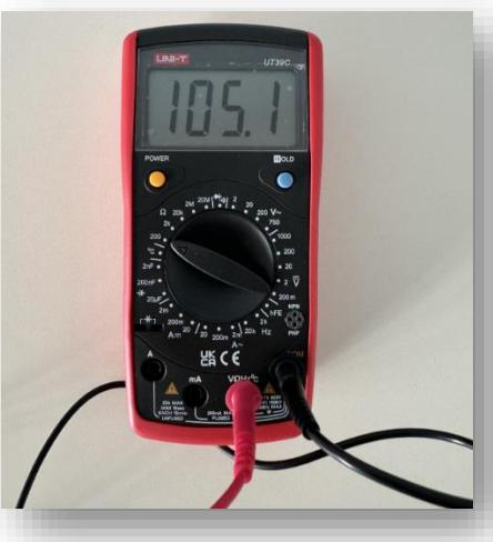
Slika 11: Testna meritev upornosti na piezo senzorju (lasten vir)
