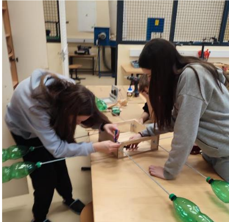
SLIKA 18: SESTAVLJANJE NAVOJNIH PALIC IN PLOVCEV Z OHIŠJEM (SLIKOVNI VIRI: SLIKA 18).
