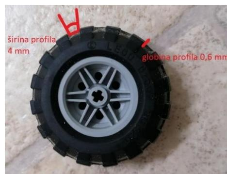
Slika 8: Kolo s pnevmatiko (lasten vir)
