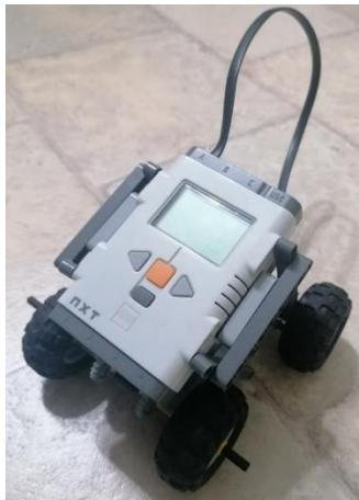
*Slika 9: Sestavljen robot LEGO Mindstorms brez IR senzorja (lasten vir)*
