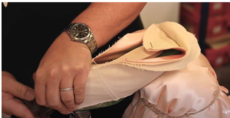
Slika 4: Pritrjevanje treh plasti blaga na podplat (Suffolk, 2022)
