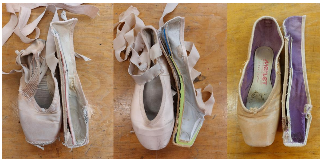
Slika 10: Prerez treh različnih špic copat (lasten vir)
