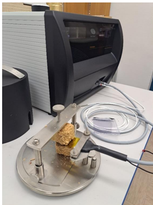
Slika 11: Merjenje toplotne prevodnosti micelija
