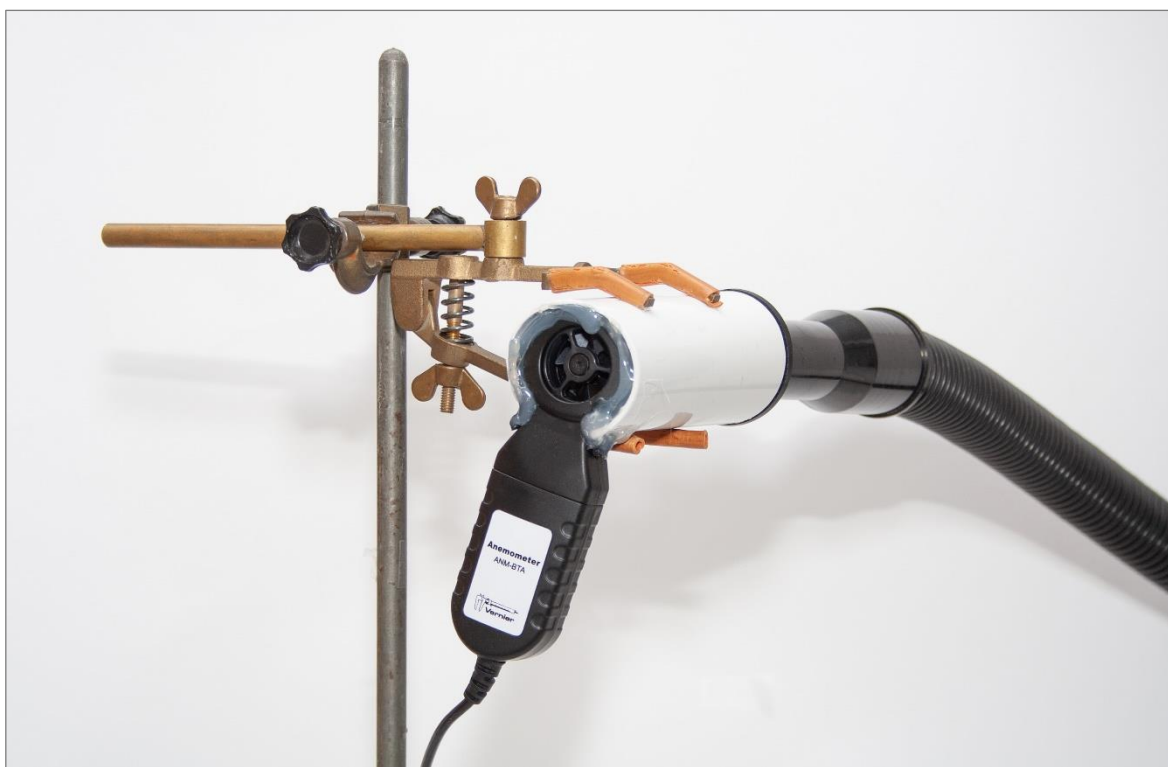
Slika 4: Merjenje hitrosti zraka skozi cev
