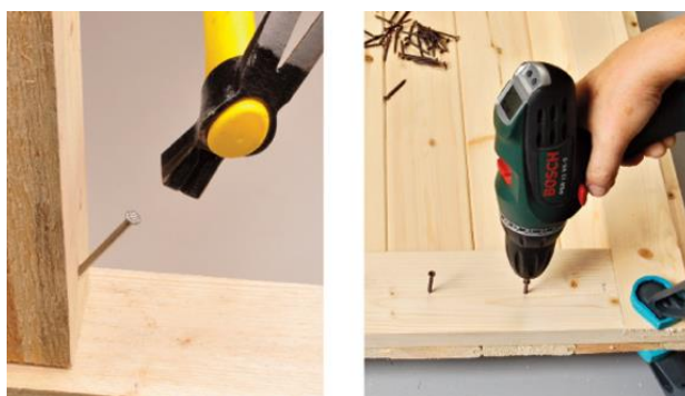
Slika 6: Žebljanje in vijačenje je v trši les zahtevnejše
