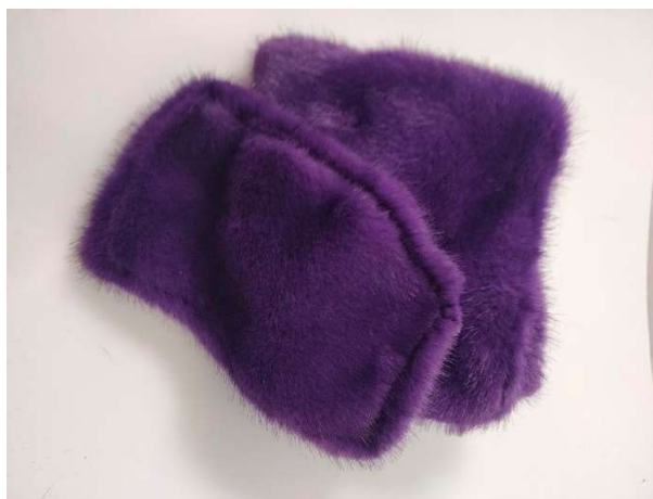
Slika 19: Primerjava izgleda materiala po desetih pranjih in sušenjih z referenčnim neopranim materialom iz recikliranih plastenk.
