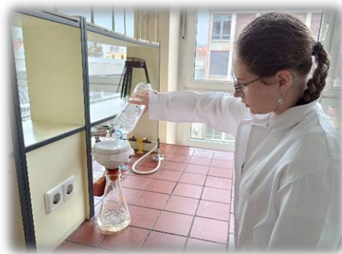
Slika 44: Vakuumsko filtriranje naravnih negaziranih ustekleničenih vod
