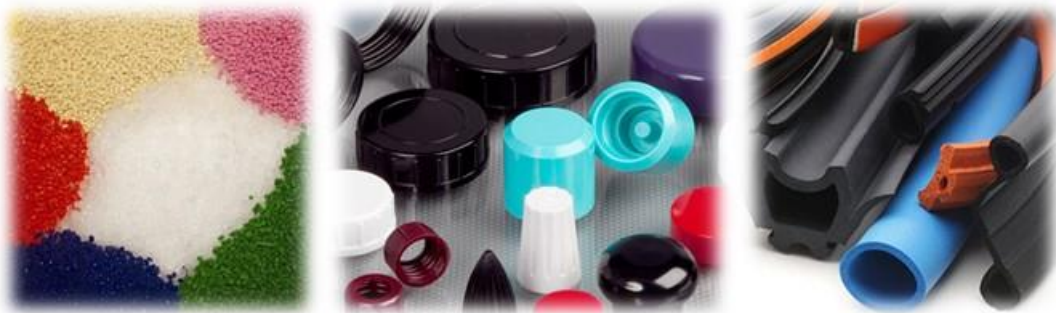
Slika 5: Termoplasti (levo), duroplasti (sredina) in elastomeri (desno) [18, 19, 20]
