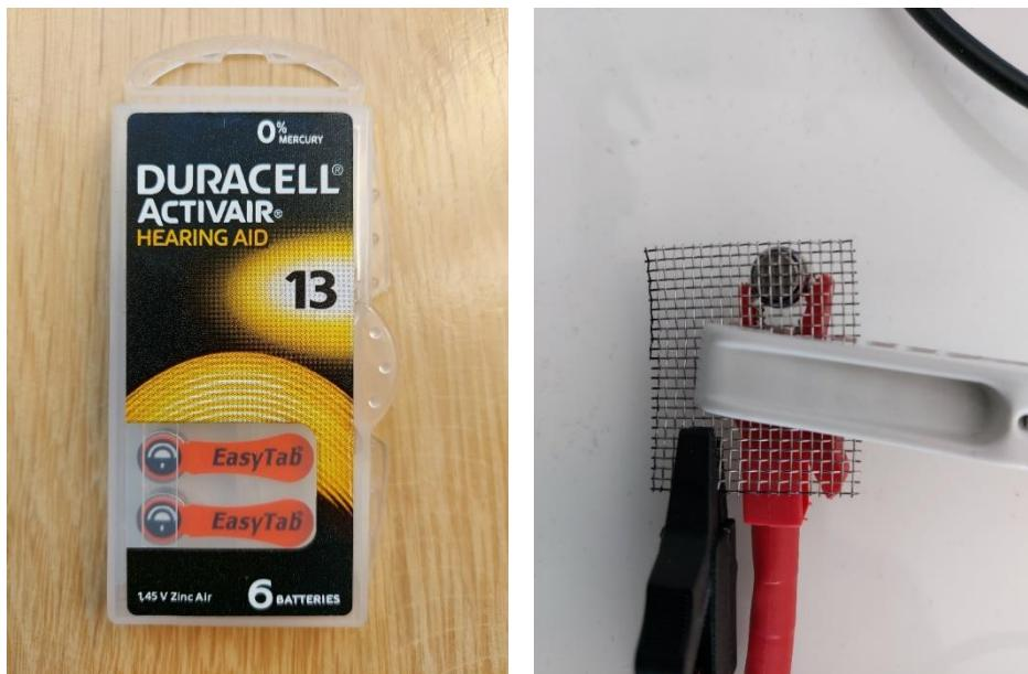
Slika 35: Komercialna baterija DURACELL TIP 13: levo. Priklop baterije na meritno napravo SIGLENT: desno (lasten vir)
