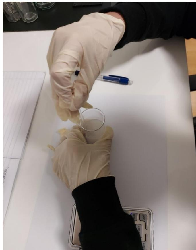
Slika 14: Priprava elektrolita: raztopljanje KOH v destilirani vodi (lasten vir)
