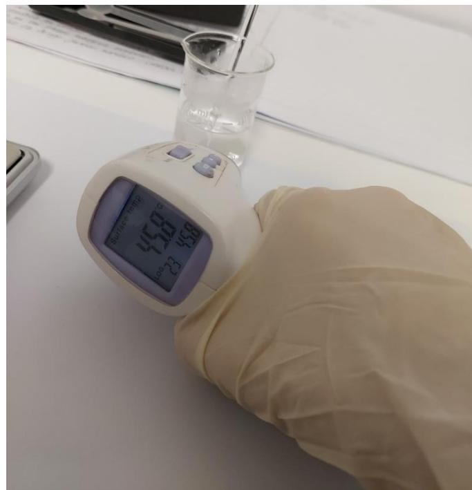
Slika 15: Eksotermna reakcija pri raztopljanju KOH v destilirani vodi (lasten vir)
