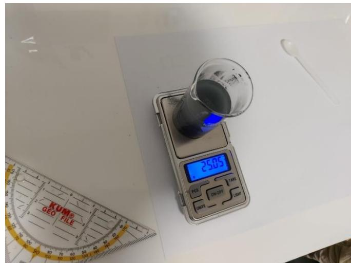
Slika 17: Tehtanje cinkovega prahu (lasten vir)
