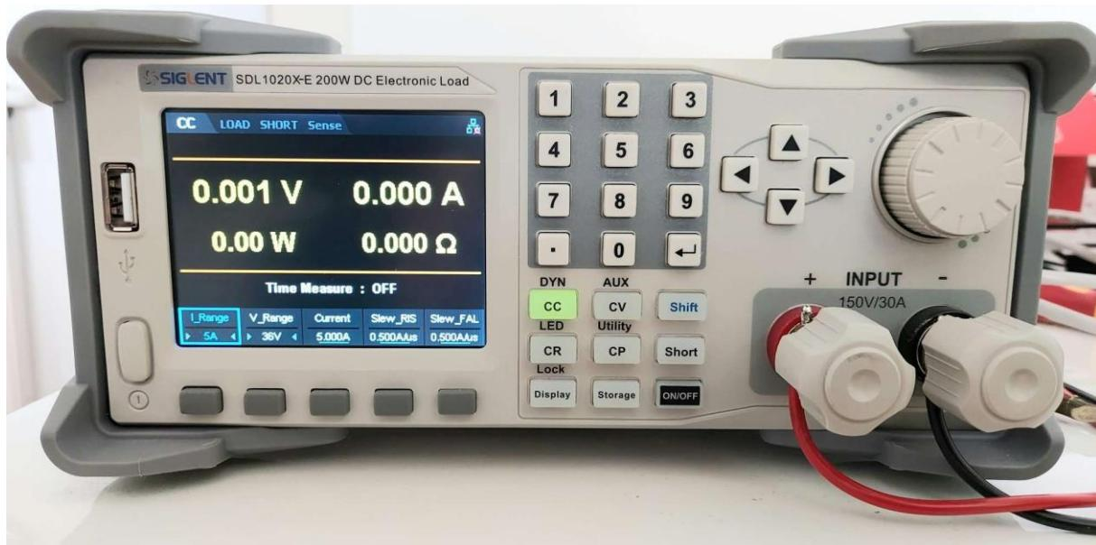
Slika 32: Elektronsko breme SIGLENT SDL1020X-E (lasten vir)
