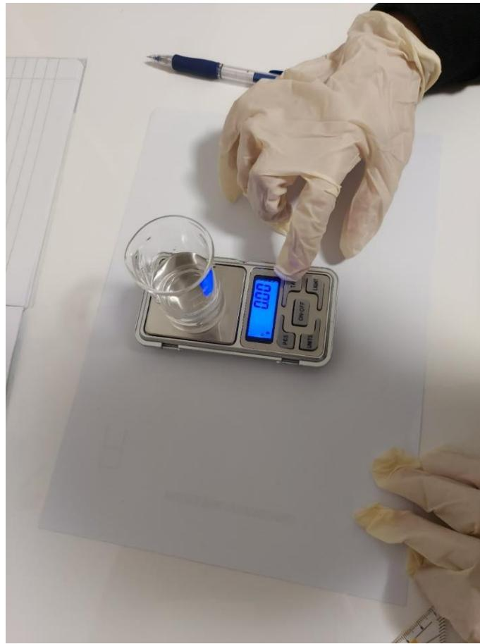
Slika 12: Čaša z destilirano vodo, nastavitev ničelne teže (tara) na tehnicni (lasten vir)
