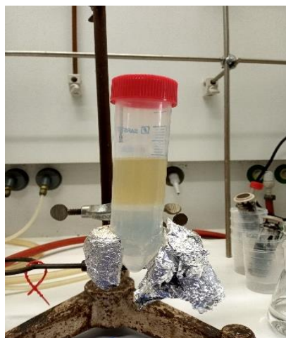
Slika 14: (a) Prvo spiranje poliola s HCl (b) Poliol po čiščenju
