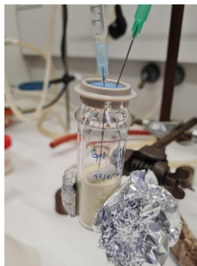
Slika 11: (a), (b): Prepihovanje reakcijske zmesi z dušikom ( N_2 )
