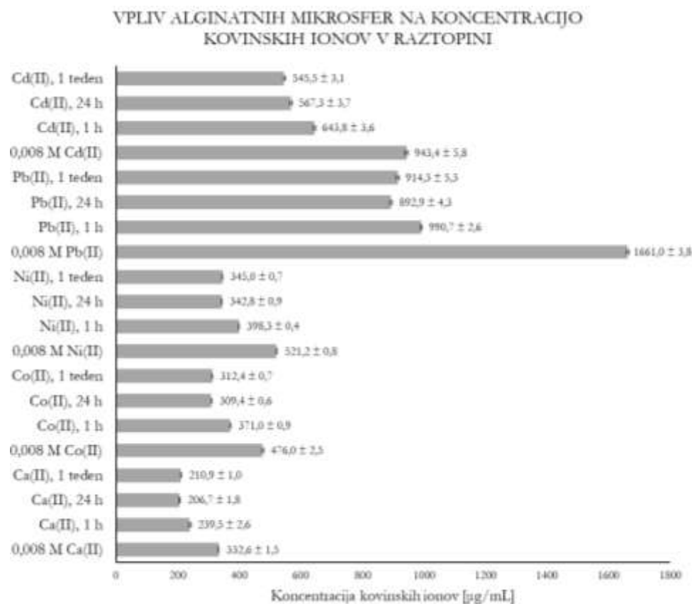
Graf 1: Vpliv alginatnih mikrosfer na koncentracijo kovinskih ionov v raztopini. Koncentracija ionov v destilirani vodi je, v enoti µg/mL, pod mejo zaznave; Ca(II): < 0,43 (LOD = 0,00086), Cd(II): < 0,24 (LOD = 0,00048), Co(II): < 0,29 (LOD = 0,00059), Ni(II): < 0,36 (LOD = 0,00073), Pb(II): < 0,98 (LOD = 0,00196).
