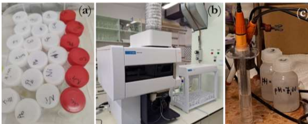
Slika 8: (a) Raztopine po filtraciji, pripravljene za (b) meritve vsebnosti ionov težkih kovin z ICP-OES in (c) določitev pH vrednosti.
