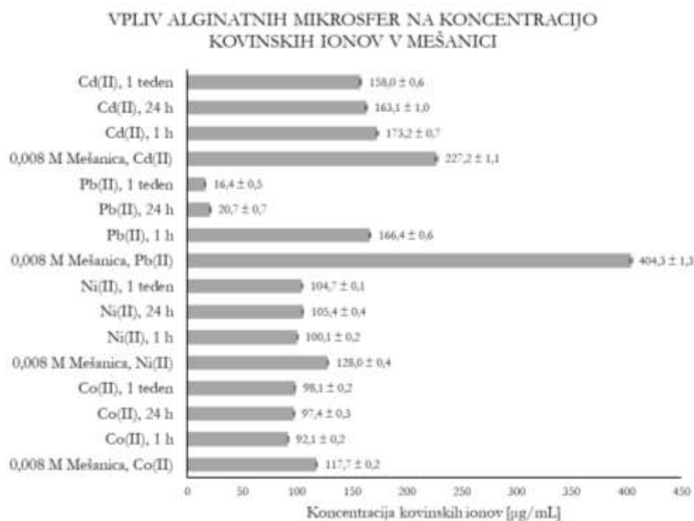
Graf 2: Vpliv alginatnih mikrosfer na koncentracijo kovinskih ionov v mešanici. Koncentracija ionov v destilirani vodi je, v enoti µg/mL, pod mejo zaznave; Cd(II): < 0,24 (LOD = 0,00048), Co(II): < 0,29 (LOD = 0,00059), Ni(II): < 0,36 (LOD = 0,00073), Pb(II):
