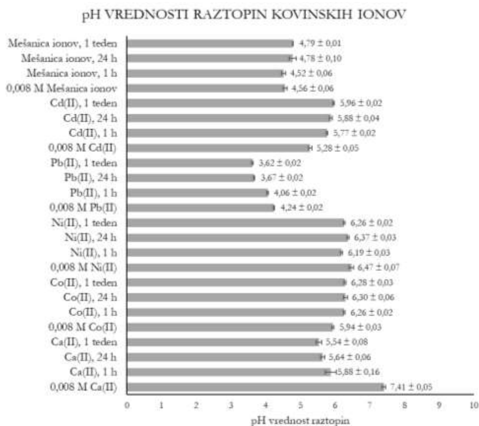
Graf 3: pH vrednosti raztopin kovinskih ionov kontrolnih vzorcev in vzorec po odstranitvi alginatnih kroglic.
