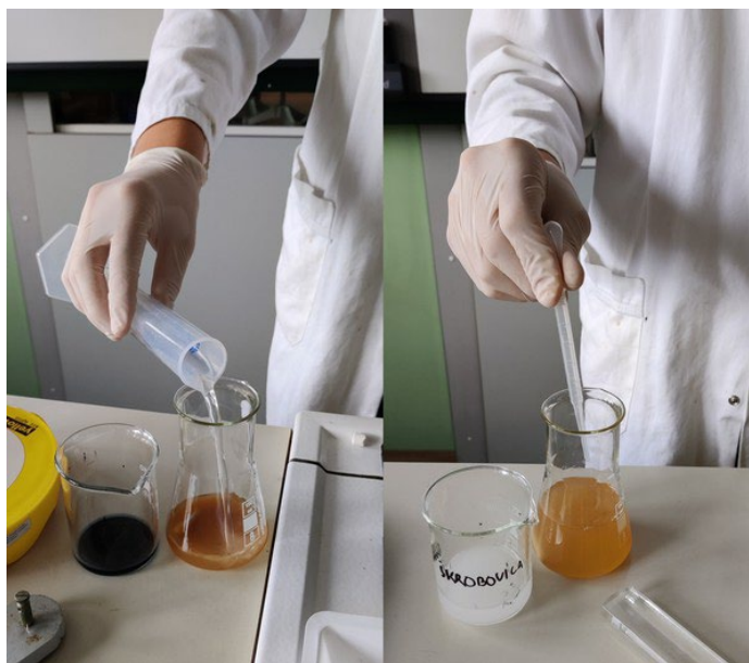
Slika 7: Priprava vzorcev za titracijo Vir: osebni arhiv
