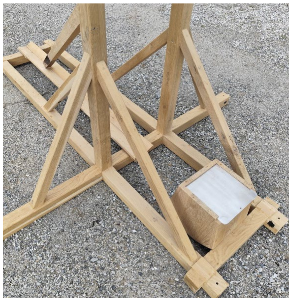
Slika 33: Lesen zaboj s protiutežjo (levo) in podnožje triboka (desno) med izdelavo.
