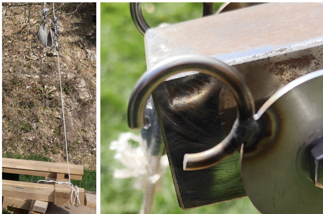
Slika 37: Mošnja s pripeto vrvico, ki zaustavi mošnjo v zelenem kotu izmeta (levo) in vpetje mošnje, ki pod določenim kotom samodejno sprosti eno vrvico, s katero je vpeta mošnja (desno).
