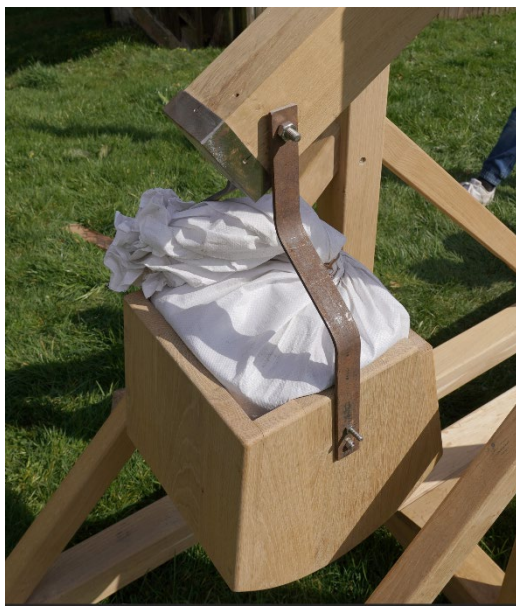
Slika 33: Lesen zaboj s protiutežjo (levo) in podnožje triboka (desno) med izdelavo.
