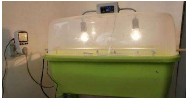
Slika 18: Izdelana posoda za vzgojo sadik čilija (Foto: K. Muha)
