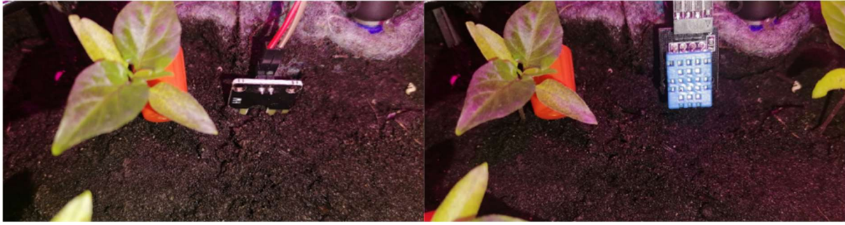
Slika 25: Namestitev senzorja vlage in temperature (foto: K. Muha).
