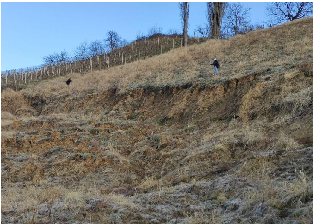
Fotografija 18: Krona in glava plazu, Grušeni, meritev širine krone plazu, foto: Mari Karnet, 21. 12. 2023.
