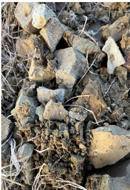
Fotografija 23: Vzorec št. 1 - lapor na površju hitro prepereva, Grušena, foto: Klara Stajnko, 21. 12. 2023.
