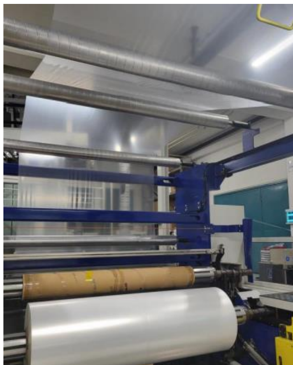
Slika 11: Navijanje folije na kolute
