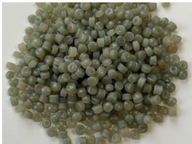
Slika 23: Regenerat nastal po reciklaži folije
