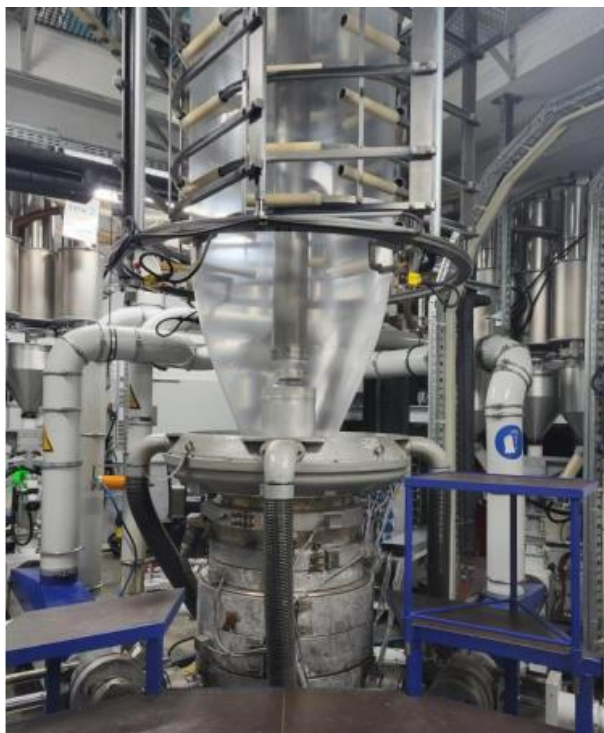
Slika 8: Mehur, ki potuje proti stropu in v višja nadstropja
