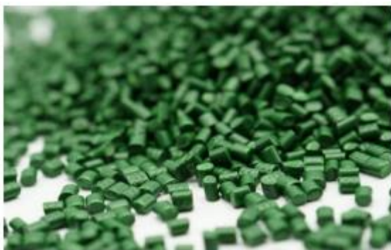
Slika 7: Aditivi za barvo in UV zaščito
