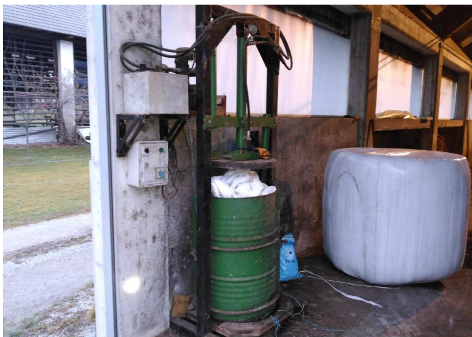
Slika 16: Doma narejena stiskalnica za odpadno silažno folijo
