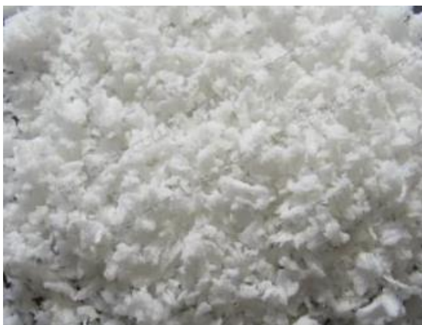
Slika 22: Posušeni ostanki zmlete in prečiščene odpadne folije
