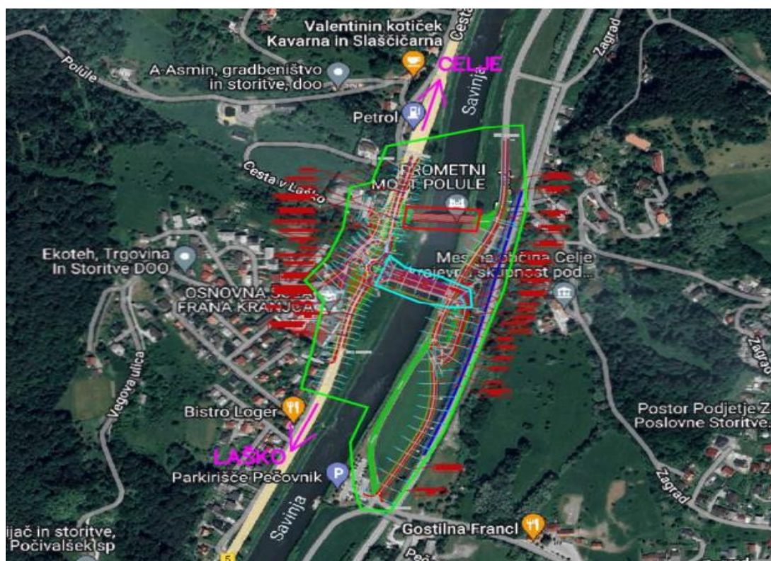
Slika 74: Most na Polulah, ki bo porušen (rdeča barva), in predviden novi most (modra barva) ( Lineal, Projekt št. 1671/julij 2023, 6 )
