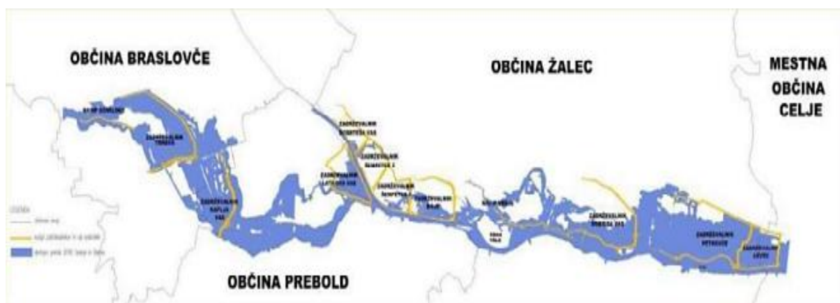
Slika 60: Poplavne površine, ki so določene s hidravličnimi modeli ob enakih pretokih (Projektna dokumentacija DGD, št. 39/22, 3)
