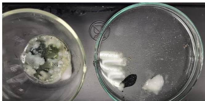
Slika 14. Primerjava med reakcijo z \text{NaHCO}_3 pri oksidaciji etanola z dikromatnimi ioni (levo) in produktu reakcije etanola z Myrkl® (desno)
