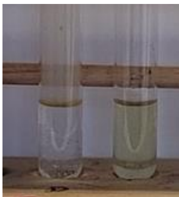
Slika 11. Reakcija vodne raztopne Myrkla s kislno raztopno kalijevega dikromata(VI) (levo pred reakcijo in desno po reakciji).
