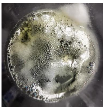
Slika 13. Reakcija med \text{NaHCO}_3 in produktom oksidacije etanola s \text{K}_2\text{Cr}_2\text{O}_7/\text{H}^+
