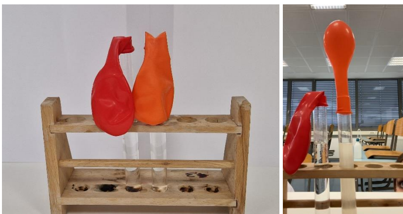
Slika 15. Kvantitativni poskus – količina sproščenega \text{CO}_2 ob dodatku etanola (levo pred dodatkom Myrkl® mikroorganizmov in desno po dodatku)
