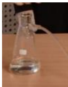
Slika 18. Presesalna buča za uvajanje CO 2 v baritovico
