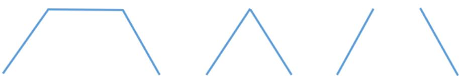
V programu smo se odločili, da bomo v času pospeševanja brali, kolikokrat se motor B zasuče. Pri tem vemo, da je dolžina pospeševanja približno enaka dolžini zaviranja. Ker pa se naš robot že giblje in elektro motor ne zavira, smo programu dodali še dodatnih 100 rotacij, da lahko vedno ujame napako. Tako ima naš program sledeče stopnje:
