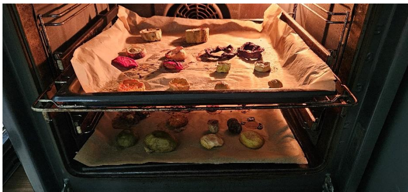
Slika 15: Sušenje vzorcev v kuhinjski ventilacijski pečici (Foto: Brina Benko)
