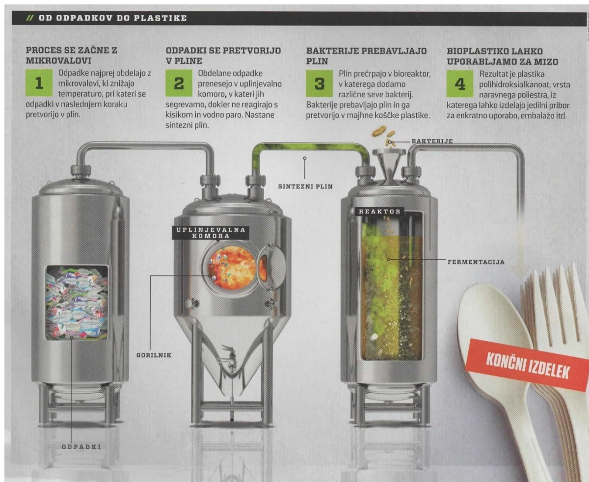
Slika 19: Nastajanje biorazgradljive plastike, vir: 25
