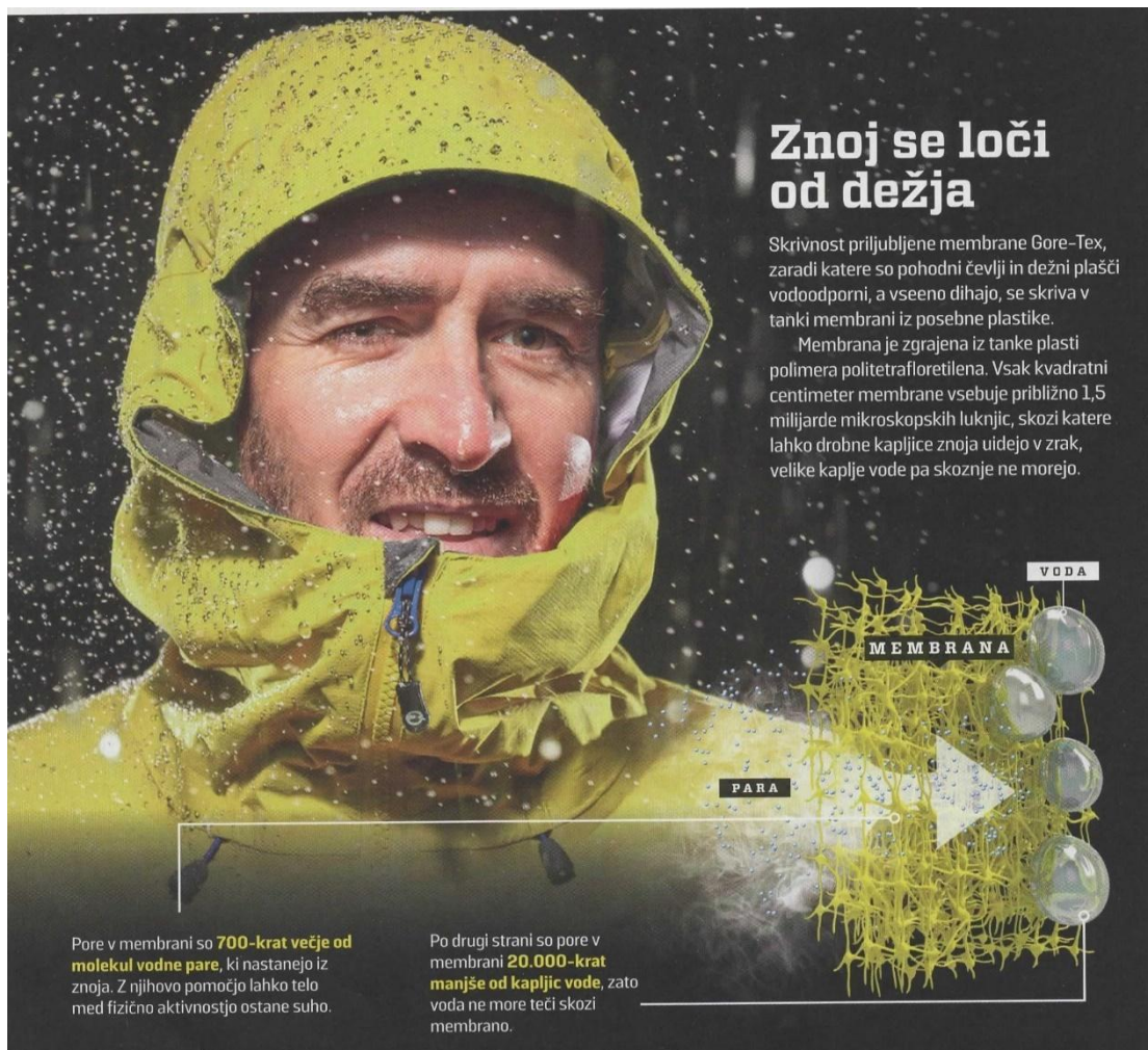
Slika 12: Plastična membrana, ki prepušča znoj a ne vode, vir: 18
