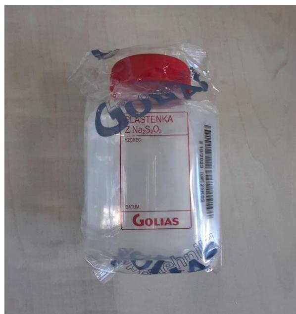
Slika 14: Plastenka za odvzemanje vzorcev vode
