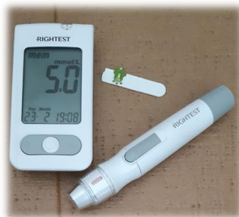
Slika 41: Aparat za merjenje sladkorja v krvi (glukometer)
