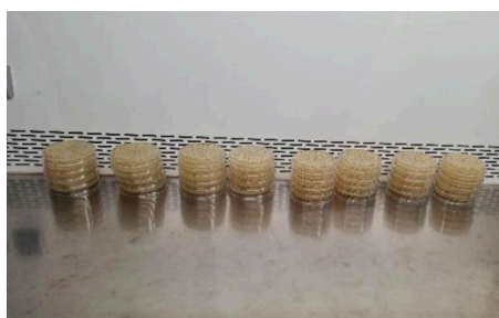
Slika 19: Plošče z Mueller-Hintonovim gojiščem, pripravljene za testiranje po metodi difuzije z diski (vir: osebni arhiv)
