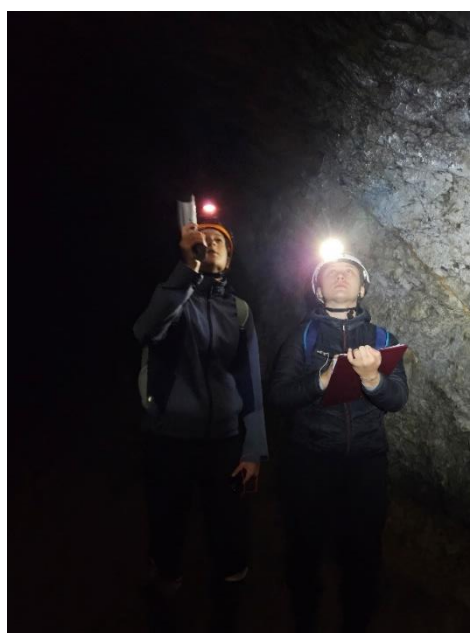
Slika 10: Merjenje temperatur sten okoli netopirjev z ročnim laserskim merilcem (foto osebni arhiv, 2023)
