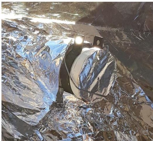
Slika 18: Kapsula s senzorjem v gorišču. 2023.
