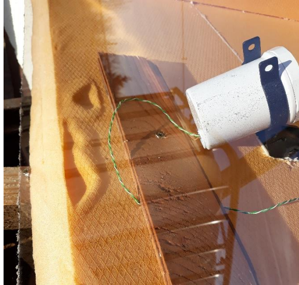
Slika 15: Stopljen ekstrudiran polistiren. 2023.
