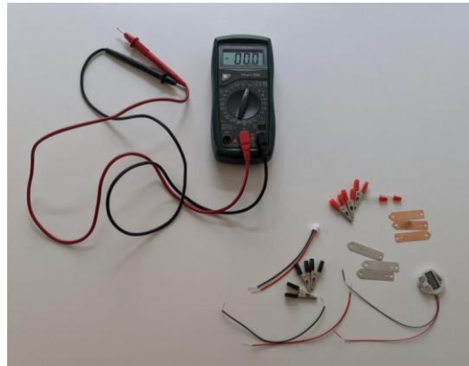
Slika 3: Multimeter, elektrode (baker in cink), žičke, dioda LED in digitalna urica
