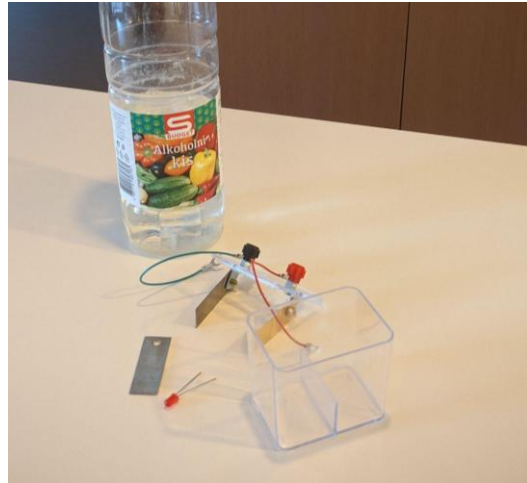
Slika 1: Posodica za elektrolit, alkoholni kis (elektrolit) in elektrode
