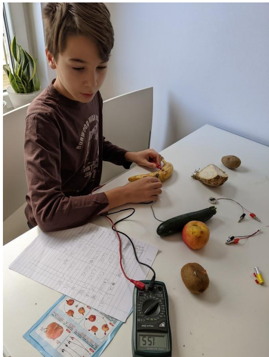
Slika 4: Prikaz izvedbe meritev napetosti pri uporabi različnega sadja
