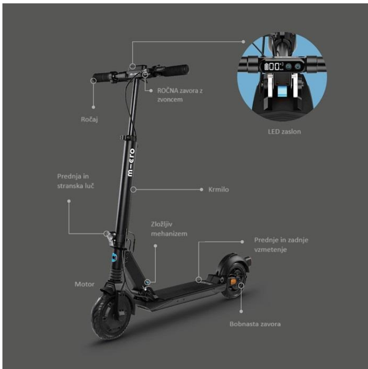
Slika 4: Sestava električnega skiroja.
