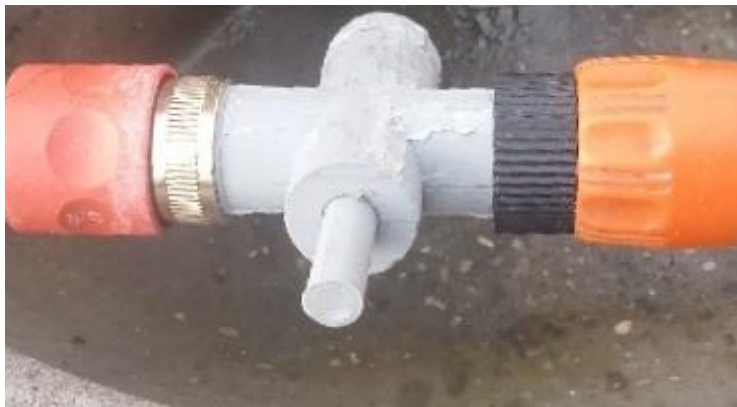
Slika 11: Testiranje izdelanega mešalnega ventila (Rap, 2023)
