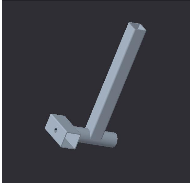
Slika 7: 3D-model nagibnega dela rahljalnika (osebni arhiv)
