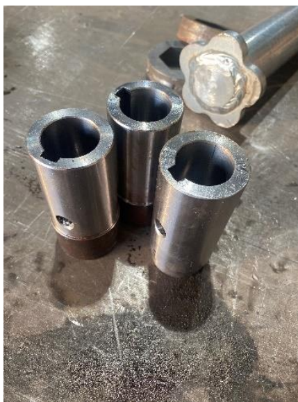
Slika 48: Izdelane utorne puše (Osebni vir)
