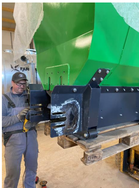
Slika 59: Deformacija pri varjenju (Osebni vir)
