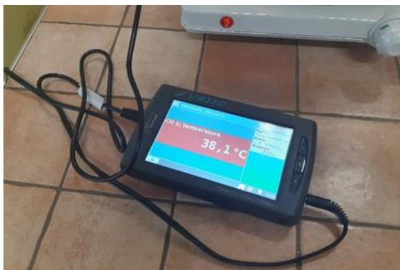
Slika 7: Zaslon merilnika temperature.
