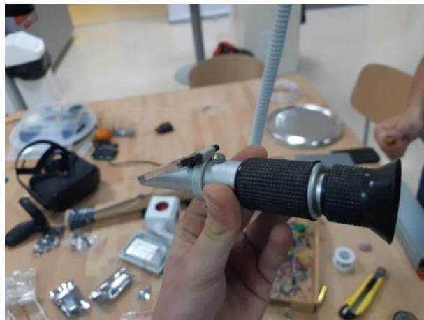
Slika 12: Refraktometer.
