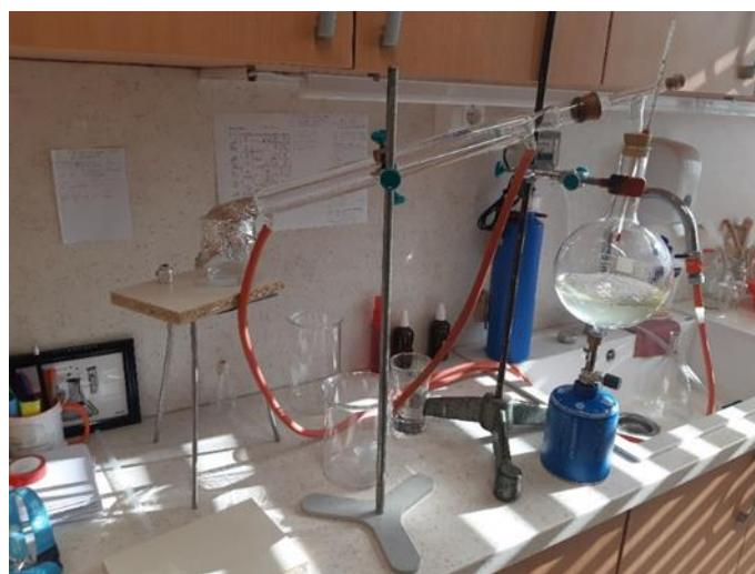
Slika 9: Laboratorijska destilacijska aparatura.
