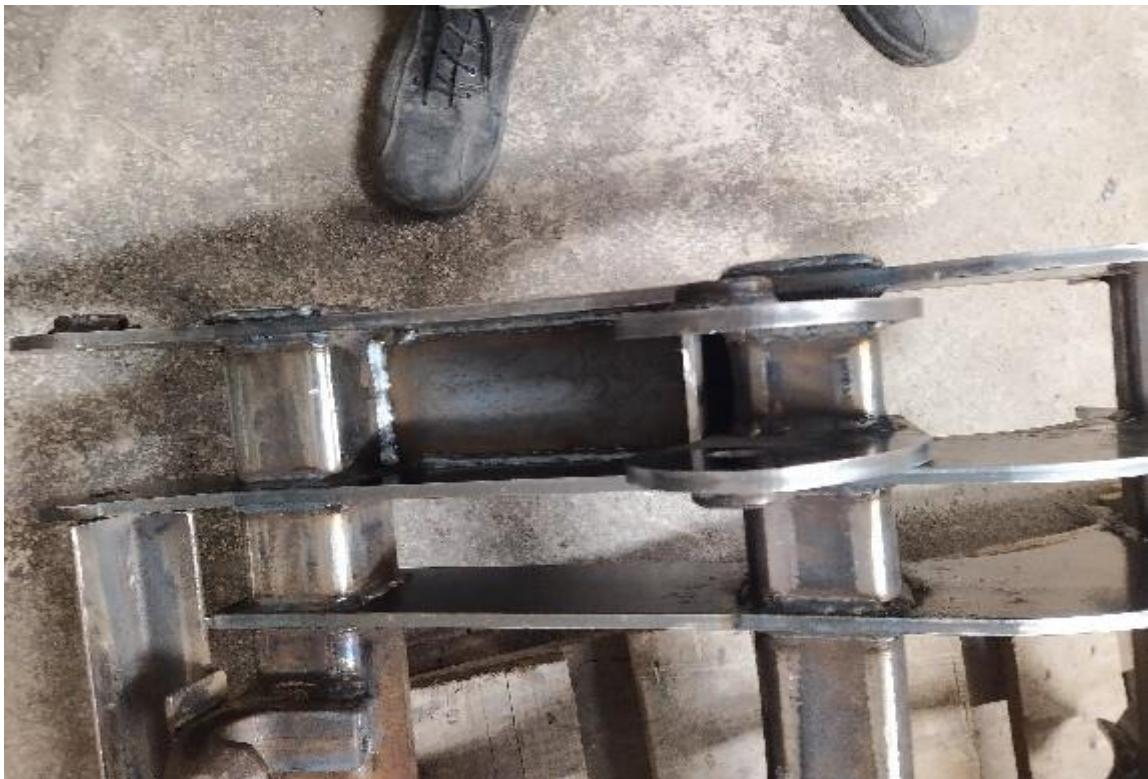
Slika 38 zaščita hidravličnega cilindra
