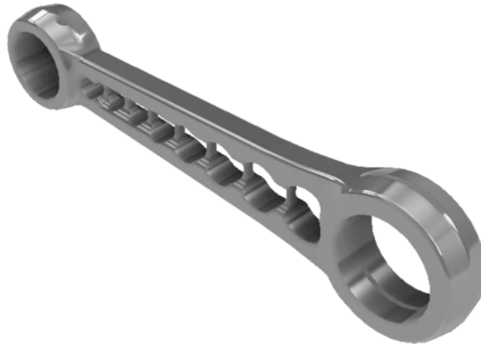
Slika 17: Model ojnice z okroglimi izvrtinami.
