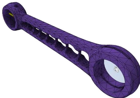
Slika 18: MEK model ojnice z okroglimi izvrtinami.
