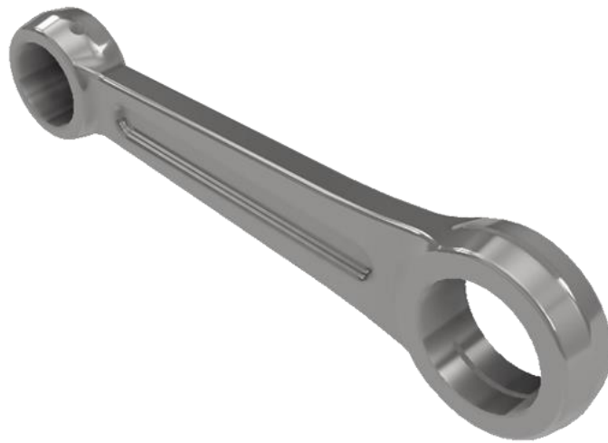
Slika 5: numerični model vzorčne ojnice.
