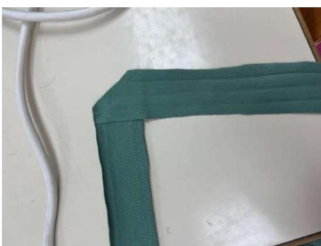
Slika 38: Šivanje paspulnega traku
