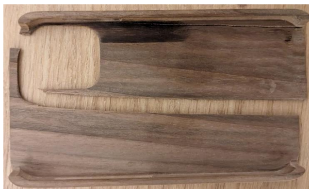
Slika 5: Zlomljen ovitek izvedbe z nameščanjem na klik
