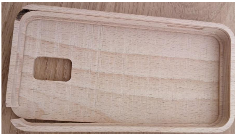
Slika 2: Zlomljen okvir izvedbe okvirne konstrukcije s hrbtom
