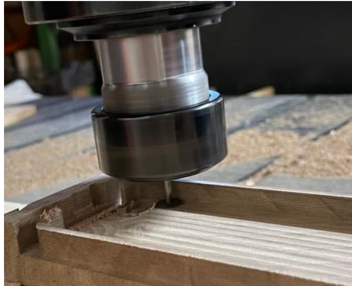
Slika 11: Rezkanje notranje stranice s T-rezkarjem
