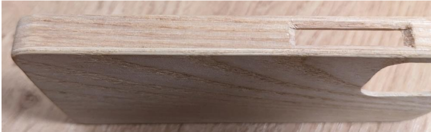
Slika 7: Ovitek izvedbe z nameščanjem na klik iz lepljenih furnirjev
