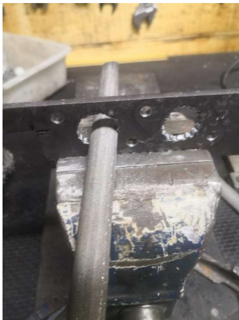
Slika 22: Izdelava prirobnic (vir: lastni)
