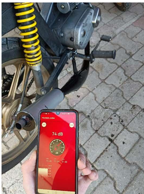
Slika 38: Merjenje glasnosti izpuha 1 (vir: lastni)
