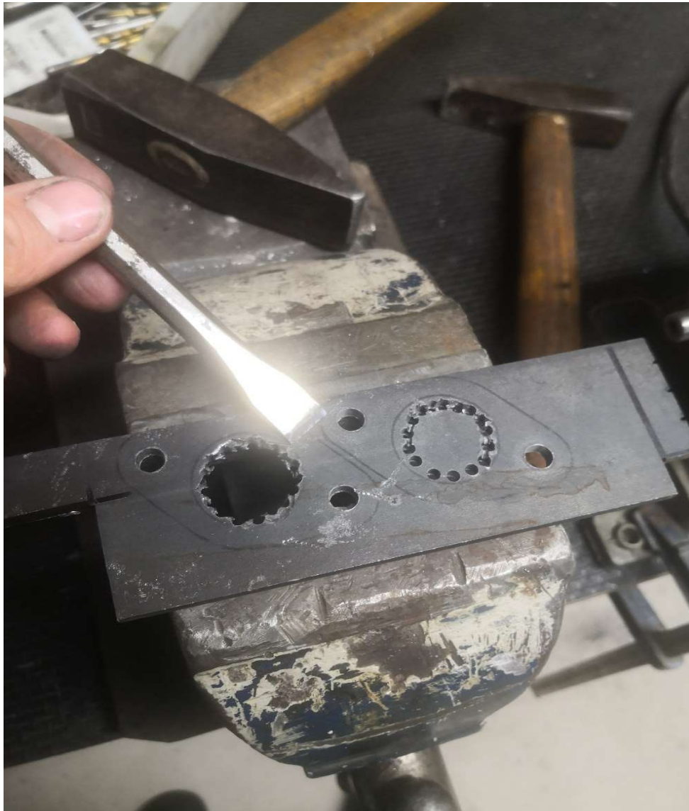
Slika 21: Izdelava prirobnic (vir: lastni)
