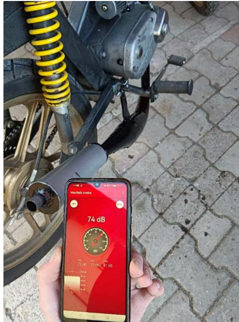
Slika 39: Merjenje glasnosti izpuha 2 (vir: lastni)
