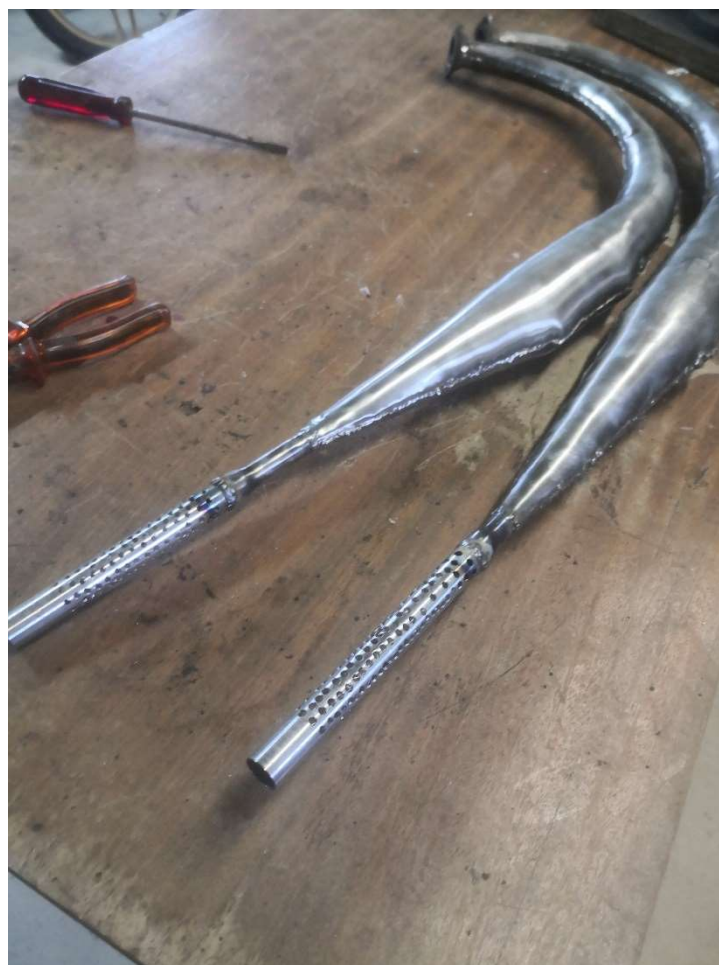
Slika 33: Prileganje izpuha na motocikel (vir: lastni)
