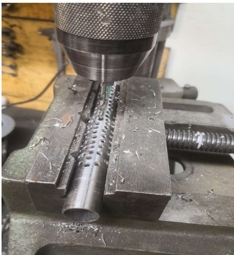
Slika 31: Izdelovanje izpušne cevi resonančnega izpuha (vir: lastni)
