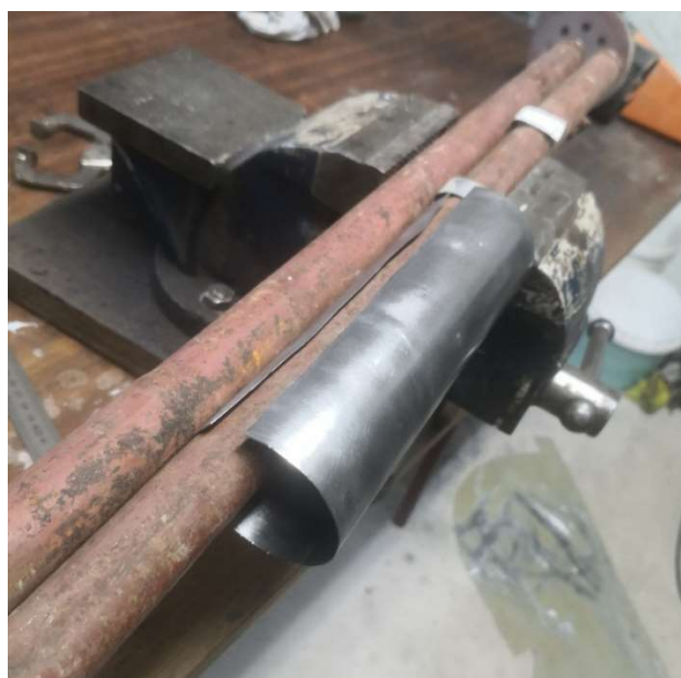
Slika 32: Izdelovanje zunanjega plašča dušilca (vir: lastni)
