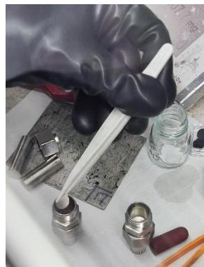
Slika 26: Polaganje separatorja v »swagelok«
