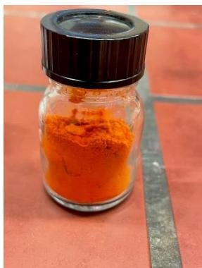
Slika 11: Aktivni material alizarin
