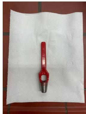
Slika 18: Sekač za izsekavanje elektrod
