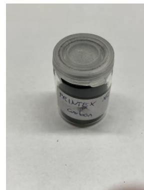
Slika 14: Prevodni ogljik (Printex XE2)
