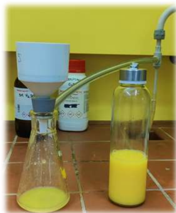
Slika 10: Aparatura za filtracijo pod znižanim tlakom
