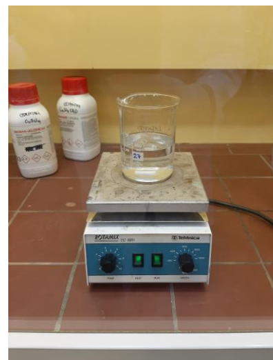
Slika 23: Odparevanje topil na električnem mešalu
