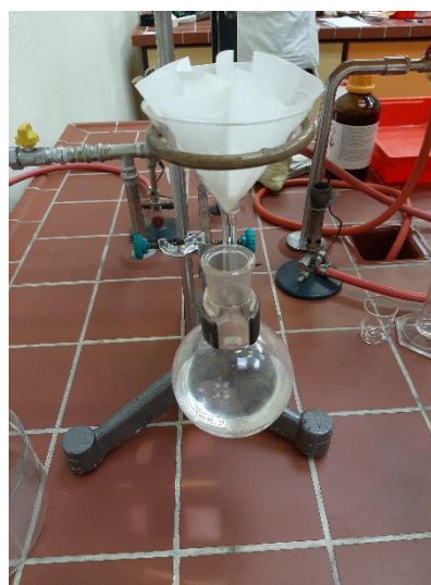
Slika 21: Filtriranje raztopine aspirina in metanola
