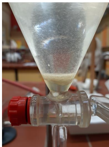
Slika 34: Meja med oljno in vodno fazo
