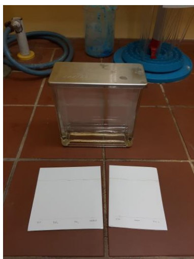
Slika 35: Stacionarna faza, odstranjena iz komore, z označeno fronto mobilne faze
