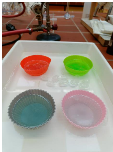
Slika 40: Hlajenje ulitih mil v ledeni kopeli
