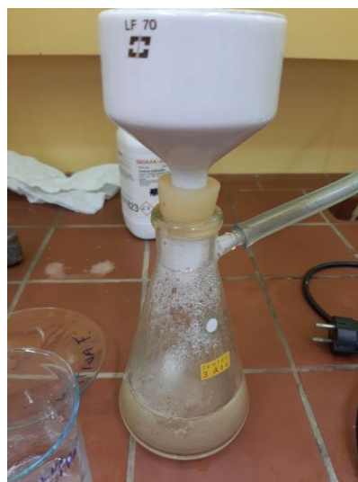
Slika 28: Nučiranje nastale salicilne kisline
