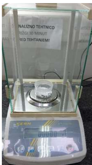
Slika 7: Tehtanje z odvzemanjem iz tehtiča na analizni tehtnici
