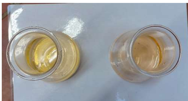
Slika 9: Levo - pred titracijo Desno - ko dosežemo ekvivalentno točko
