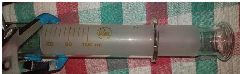
Slika 14: Naprava, iz katere se odčita količina nastalega plina.
