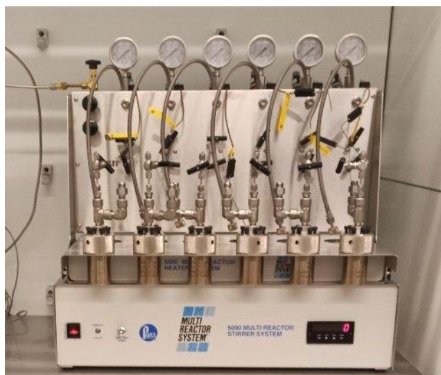
Slika 6 Reaktorski sistem, s katerim smo izvajali depolimerizacijo lignina (75 mL). 18
